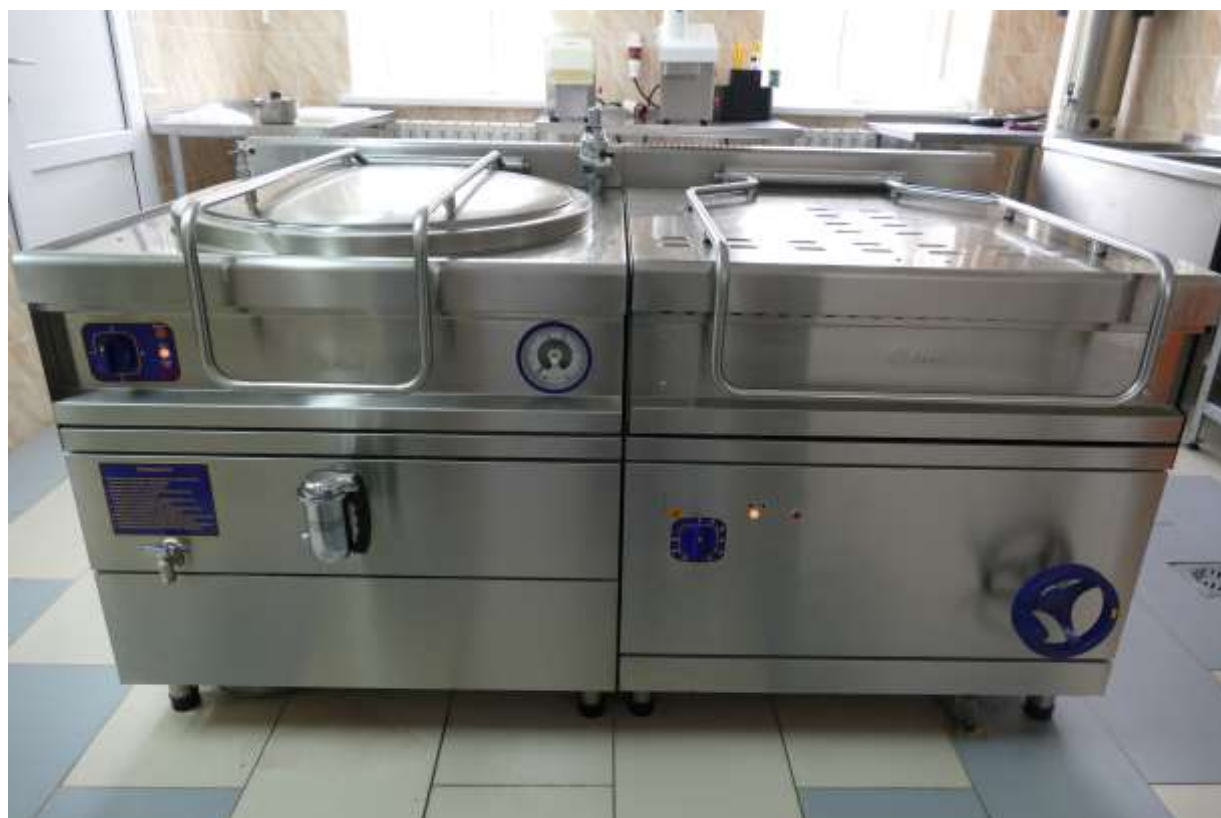
Котел и электросковорода
